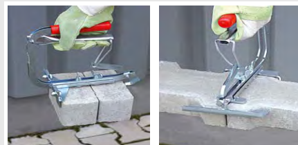
Ruční nosič zámkové dlažby
