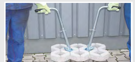
Ruční nosič zámkové dlažby
