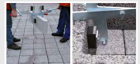
Univerzální nosič stavebních bloků
