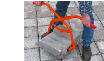
Ruční nosič betonové dlažby
