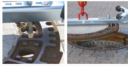
Nosič krycích odpadových vík
